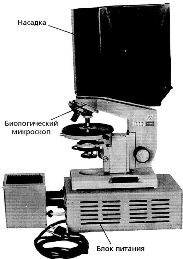
Рис. 1 – Насадка проекционная.
